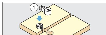
①本体とキャップを組み合わせ、連結する板の取付穴にセットします。
