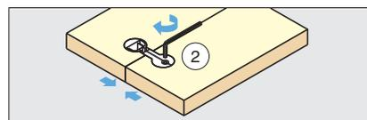
②本体の締結用ねじを六角棒スパナで締め付け、固定します。
