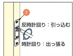
ローラーキャッチの調整ねじを回し、扉の締まる力を変えられます。
