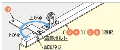
引戸ユニットA(3・4)、引戸ユニットB(5・6)のねじを緩めると扉の高さ、左右の傾きを調整できます。(調整可能範囲-6mm~0mm)
