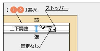
上レール(1・2)扉を戸尻側に収納した際(全開時)に保持する機構です。キャッチの保持力を調整できます。
