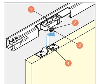
上ローラー(1)にねじ込んだハンガーボルト(2)にハンガープレート(4)の溝を掛け固定します。
