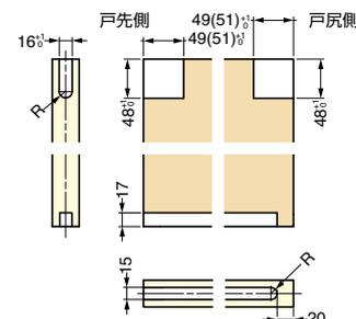
※<sup>1</sup>寸法は連動用扉付下ガイド ⑤、枠付下ガイド ⑥のガイドブロックを替えて対応します。
