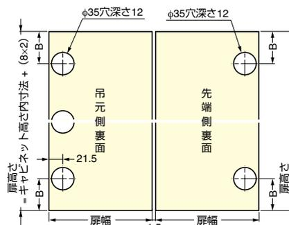
$$\text{扉幅} = \frac{\text{キャビネット幅内寸法} - 1.5 + (8 \times 2)}{2}$$
