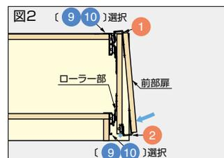
図2のようにキャビネット上のレール⑨⑩に前部上ローラー①をのせ、前部下ローラー②のローラー部を指で下げ、扉下部をレールに押しあてます。指を離すと、バネによりローラーが上がりレールにはまります。
