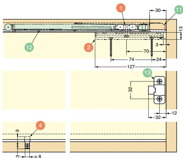
レール (シングル 掘込用) ⑥⑦使用時 レール (ダブル 面付用) ⑧⑨使用時
