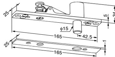
●引き込み式φ15mmのピボットピンとカバープレート付き。
