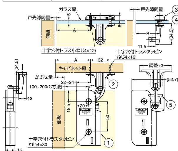
インセット扉の場合、本体のキャビネット小口面からの取り付け位置は扉の厚み分、内側に付けてください。(DC-90型、DC-100型共)
