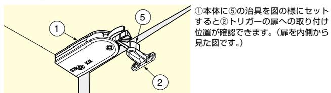
①本体に⑥の治具を図の様にセットすると②トリガーの扉への取り付け位置が確認できます。(扉を内側から見た図です。)
