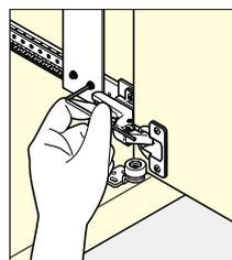
扉が垂れ下がっている（動きが悪い）場合は、連動板のねじを緩めて扉を持ち上げぎみにし、再度ねじを締め込んでください。
