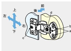
上下(±1mm): aの取付ねじを緩めた後、bの穴にプラスドライバーを差し込み、回して調整します。(調整後、aを締めてください。)
