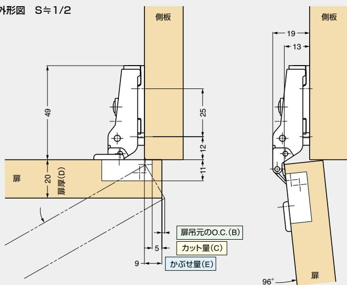
本図は、カット量5mm、扉厚20mm、9mmかぶせ仕様で、M100-34/9、またはM100-C34/9 (キャッチ付) とマウンティングプレート 100-03A (別売) の組み合わせです。
