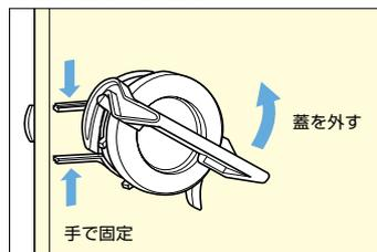
3つのパーツを電子ダイヤル錠に取り付け、蓋を外します。
