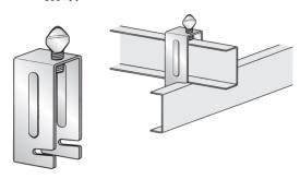
野縁受けを上図のように交差させる際に使用します。 点検口取付け時に吊り金具を使用する場合は、 野縁受けを交差(直交)させ取付けます。
